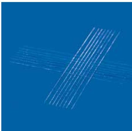
Prova di adesione con taglio trasversale.
